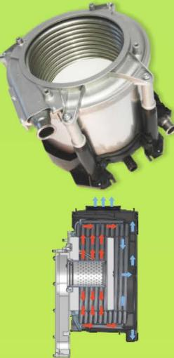
Noul schimbător de căldură ce echipăază centrala MKDens, este un schimbător de căldură integrat și compact, cu o singură serpentină din oțel inoxidabil, cu secțiune ovală. Schimbătorul de căldură este compus dintr-o cameră de ardere cu o zonă de ardere, o zonă de condensare și un disc metalic izolat, care separă cele două zone.
